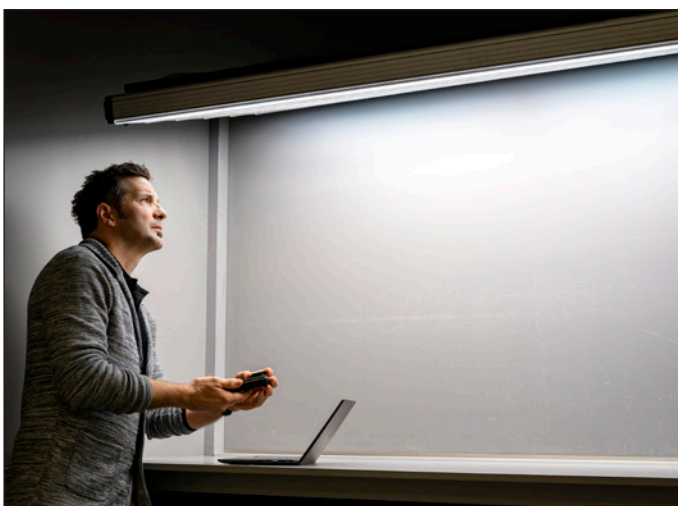
Markus Zeidler bei der Prüfung des Leuchten-Prototyps (Lux und Kelvin) mittels eines Fotometers
